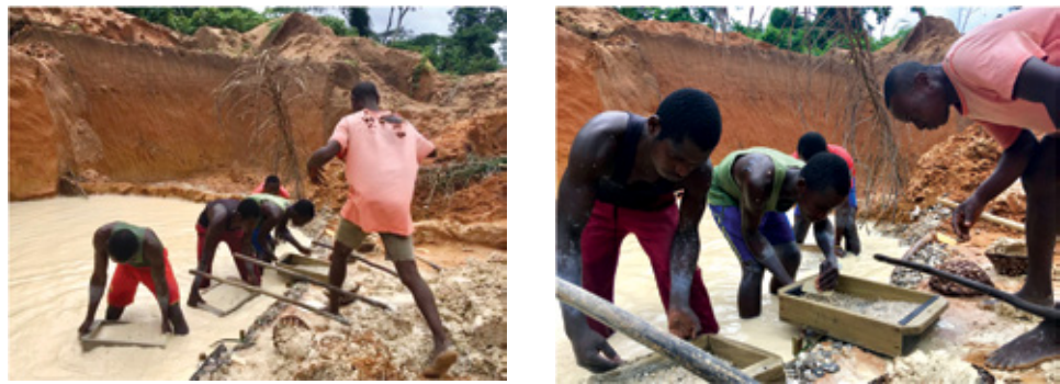
Phase de lavage du gravier, début et fin de chaque pelletée
