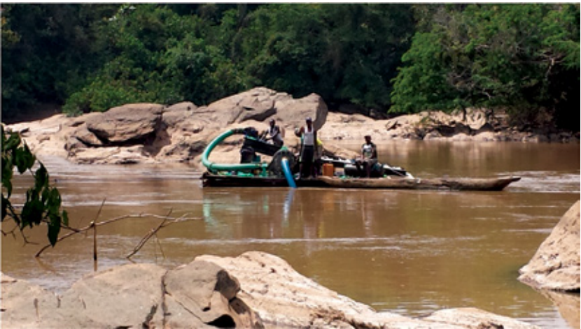
Barge et dragueuse-suceuse semi-mécanisée (RDC).
